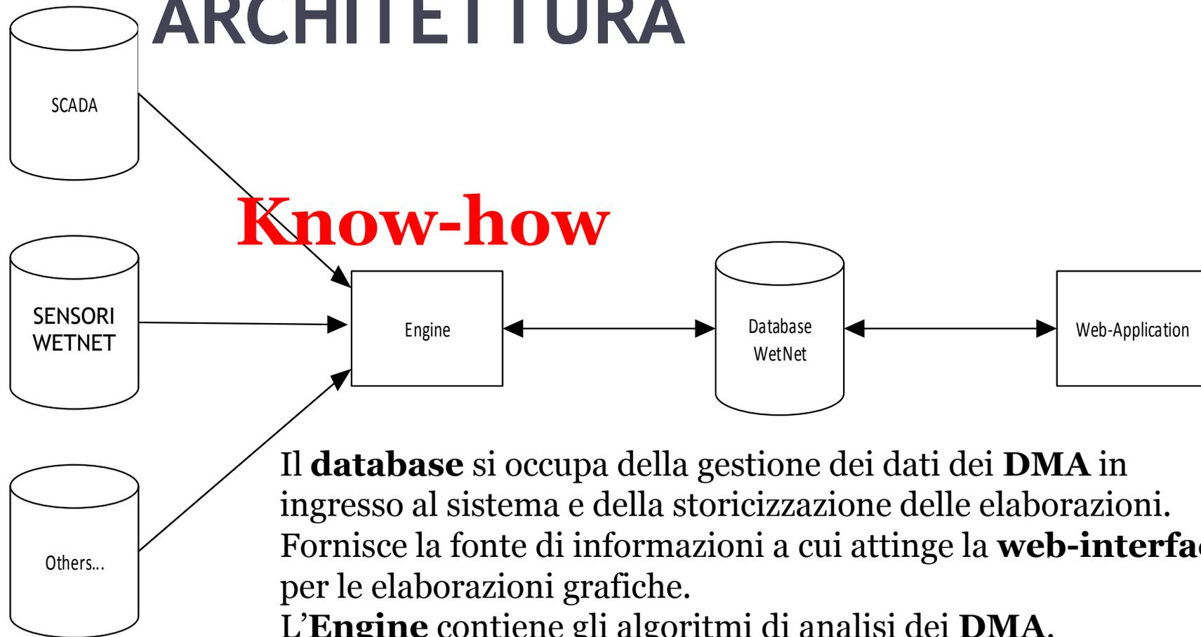
Il **database** si occupa della gestione dei dati dei **DMA** in ingresso al sistema e della storicizzazione delle elaborazioni. Fornisce la fonte di informazioni a cui attinge la **web-interface** per le elaborazioni grafiche. L'**Engine** contiene gli algoritmi di analisi dei **DMA**.
