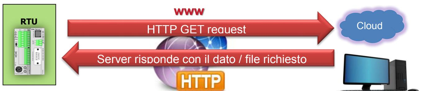
Fig. 9 – Principio funzionamento metodo HTTP GET
