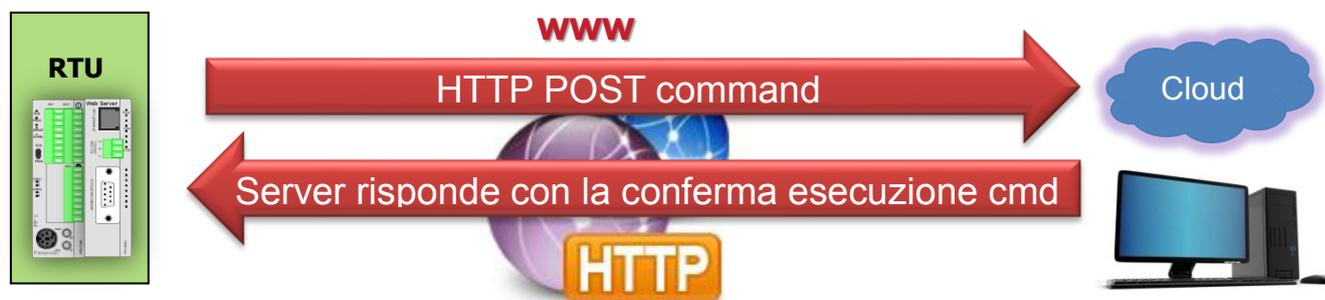
Fig. 10 – Principio funzionamento metodo HTTP POST
