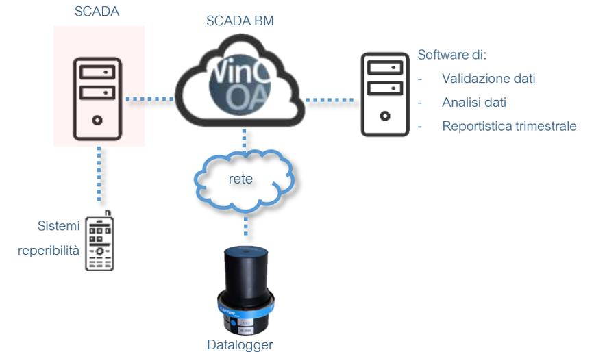
Questo progetto è stato appaltato da BriancAcque come servizio per cui l'Azienda opera direttamente da una propria piattaforma SCADA (**tecnologicamente basata sulla stessa tecnologia di quella utilizzata in BriancAcque**) che permette l'acquisizione e validazione dati per la preparazione delle analisi dei dati e l'invio a BriancAcque.
