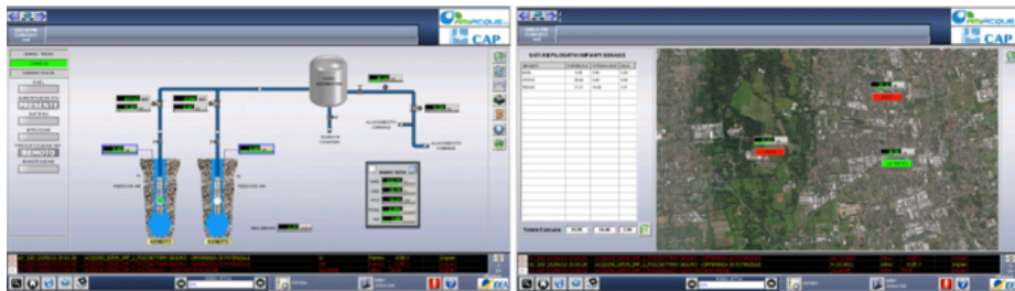
Interfaccia uomo-macchina del Centro di Telecontrollo CAP Group
